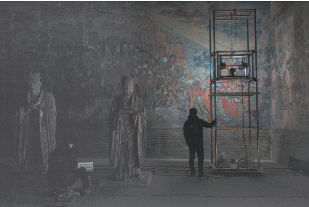
浙江大学团队使用自主研发设备在山西水神庙进行壁画高精度数字化采集
